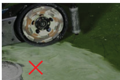
Обикновените чашковидни диамантени дискове причиняват надраскване на повърхността
