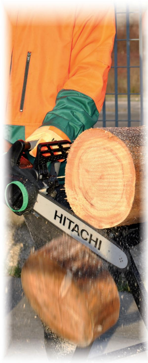
Rispetto ad una motosega con motore a scoppio, queste elettroseghe hanno un minimo impatto ambientale, senza nuocere alla salute dell'operatore. I potenti motori assicurano un'elevata velocità di rotazione della catena, per tagli precisi ed un utilizzo intenso. La rumorosità è ridotta e la manutenzione è semplice. Sui nostri modelli è inoltre possibile regolare il flusso dell'olio di lubrificazione.
