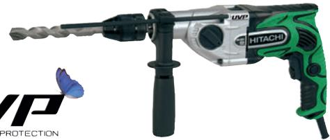
Il trapano con percussione UVP modello DM20V presenta impareggiabili caratteristiche con livelli di rumorosità e vibrazioni incredibilmente ridotti. Le vibrazioni prodotte dalla macchina vengono assorbite da un sistema flottante il quale è **composto dalle ghiera di percussione, da una molla e da un ammortizzatore**. Inoltre il corpo ingranaggi, realizzato completamente in alluminio, aumenta la durata della vita utile della macchina.
