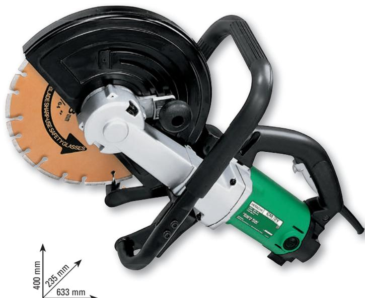
Elettrotroncatrice 2.400 W diametro disco 305 mm, ben bilanciata sulle due impugnature per ridurre al minimo la fatica dell'operatore. Il baricentro del disco si trova in linea con il motore. Il sistema di blocco dell'albero permette una facile e veloce sostituzione del disco. La capacità di aspirazione delle polveri di taglio è ottimale se utilizzata in abbinamento all'aspiratore RP35YE.
