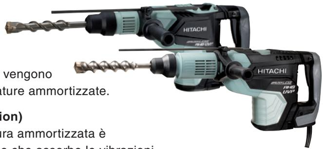
Nei martelli UVP, quando il martello è in azione le vibrazioni prodotte dalle operazioni di demolizione o perforazione vengono trasmesse attraverso il corpo macchina ad una massa sospesa, la quale vibra con frequenza opposta, entrando in risonanza. Ne consegue un efficacissimo smorzamento delle vibrazioni, senza limitare le prestazioni della macchina.
