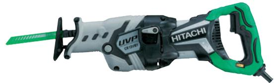
Il dispositivo UVP si compone di una massa che agisce da contrappeso, la quale si muove per mezzo di un sistema meccanico con moto reciproco rispetto all'alberino. Ad ogni escursione della lama si genera un'azione opposta del contrappeso, il quale assorbe tutta quell'energia in eccesso che non partecipa all'azione di taglio.
