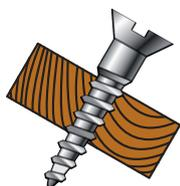
è la coppia erogata durante l'avvitatura di una vite su un materiale elastico come il legno. L'elasticità del materiale si oppone all'avanzamento della vite riducendo la coppia di serraggio.
