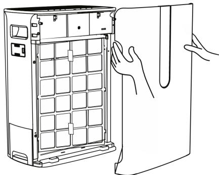
2. Scoateți filtrul principal. Țineți apăsată încuietoarea, scoateți, îndepărtați filtrul din partea inferioară a canelurii principale, închideți filtrul.
