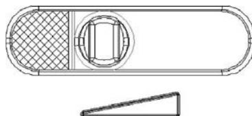
Für die Mindestleitung Primärluftregler ganz schließen. Inwiefern in dem Abgaskanal ein Schließdeckel eingebaut ist, müssen Sie diesen schließen.
